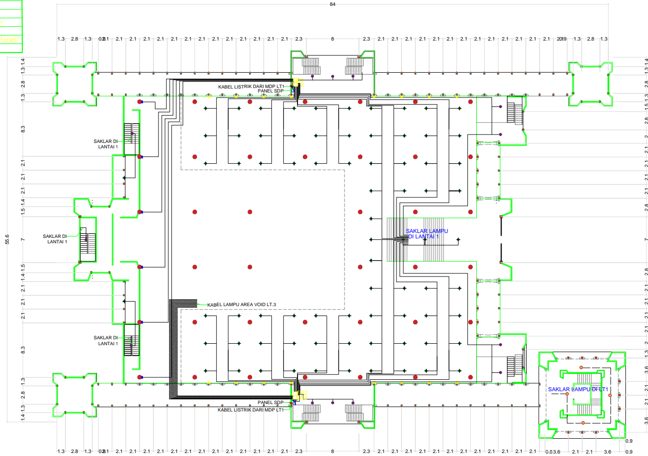
DENAH ELEKTRIKAL LANTAI 2 Skala 1: 400
