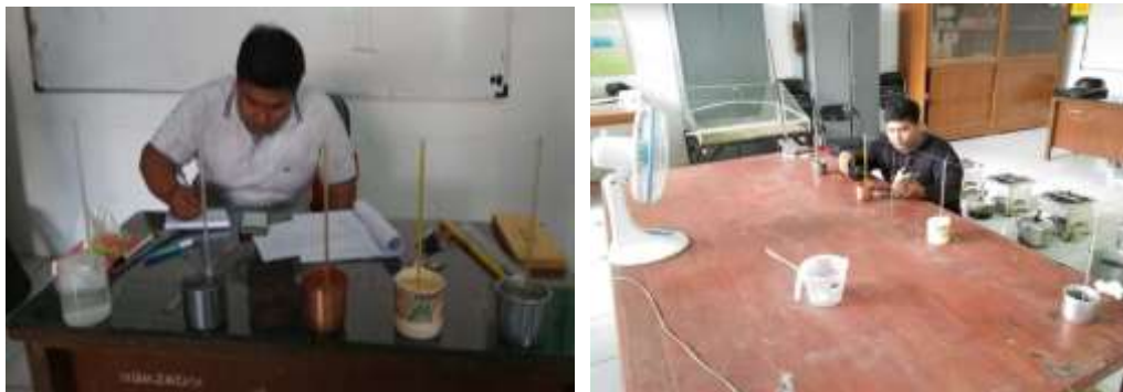
Gambar 1. Proses pengambilan data untuk proses alami dan paksa Peralatan yang digunakan untuk penelitian ini adalah termometer, anemometer, stopwatch, kompor, fan (kipas angin) dan laptop untuk menganalisis data.
