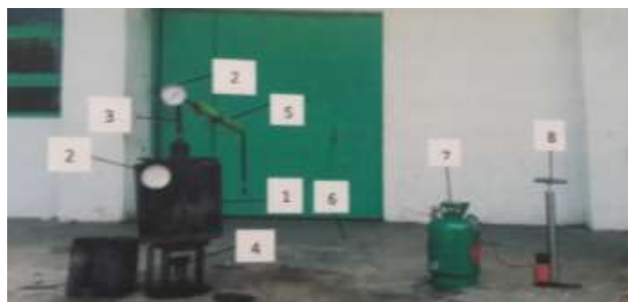
Gambar 3. Set up peralatan reaktor untuk proses pirolisis
