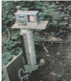
**Gambar 6. 2** Alat Pemantauan otomatis fluktuasi tinggi muka air tanah
