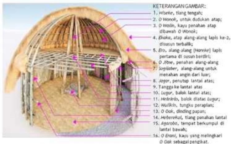
Gambar 7. Potongan Struktur Pilamo (Honai Laki-laki)
