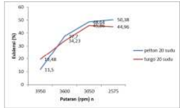
Gambar 6. Grafik efisiensi (%) terhadap putaran (rpm) pada bukaan nozzle 100% pada turbin turgo 20 sudu dan turbin pelton 20 sudu
