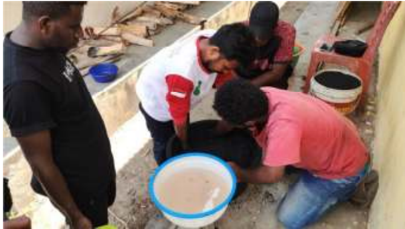
Gambar 10. Proses Pencampuran Arang dan Perakat (tapioca)
